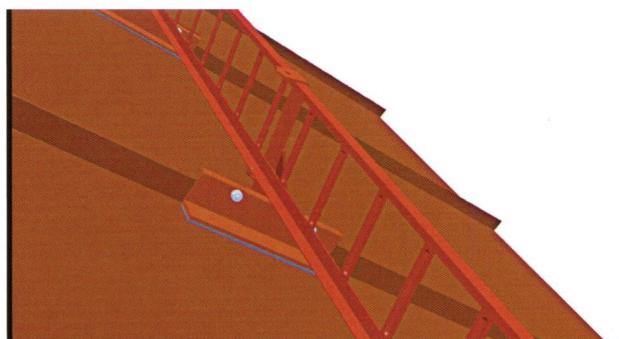
Po upevnení požadovaného počtu držiakov Falz je treba namontovať protisnehový plot. Plot montujeme v držiaku držiakov pomocou spôn.
