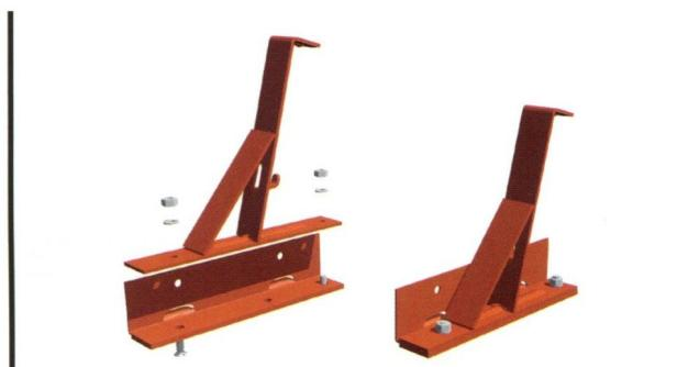
K spodnej, dvojdielej časti (konektor - v závislosti na potrebách vysoký alebo nízký) je treba pomocou skrutiek upevniť držiak protisnehového plotu. Vysoký konektor je určený pre panelové plechy - spájané na tzv. „click“, nízký konektor pre dvojitú stojatú drážku.
